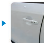
半ドアからは自動的に引き込みます(普通に閉める事もできます)
